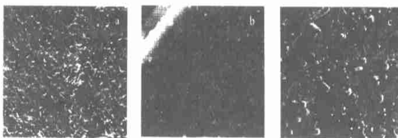
图4 样品的断口形貌(a)、ab面内 Y-211 粒子(b)和生长前沿边缘(c)
