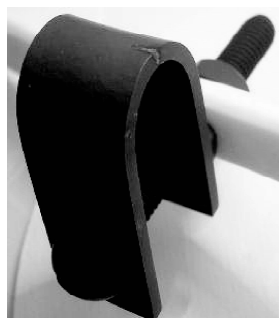
图9 270 °C、10 mg/L \text{Cl}^- 试样的 SCC 宏观形貌 Fig. 9 SCC macroscopical morphology of sample in 10 mg/L \text{Cl}^- solution at 270 °C
