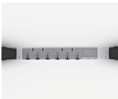
图1 燃料棒上端塞 X 射线原始图像 Fig. 1 Original X-ray image of upper end plug of fuel rod
