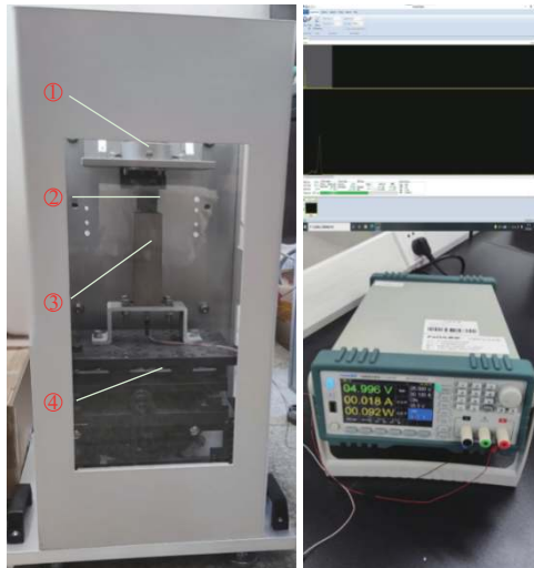
①: 放射源及放置架; ②: 样品架; ③: CZT探测器; ④: 三轴位移台; ⑤: 能谱软件; ⑥: 直流电源
