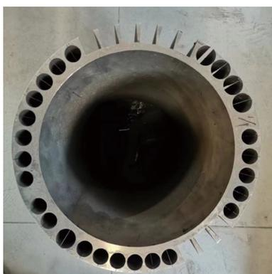
图 3 力学试样取样实物图
