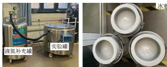
图 2 液氮冷冻装置和实验管材中形成的冰塞实物图
