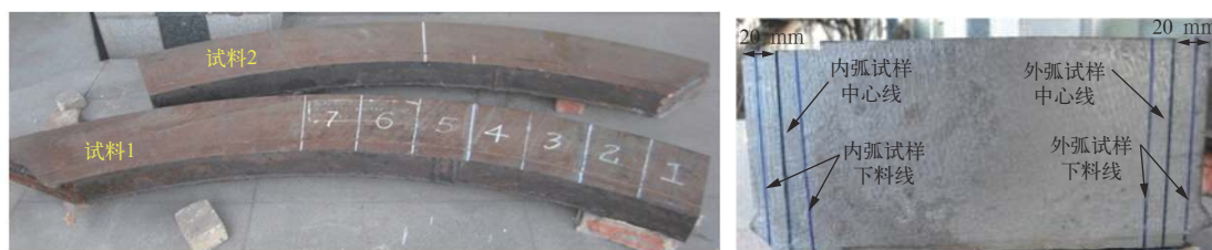
图1 国产 SA-508-III-1 钢试样的宏观形貌和下料线
