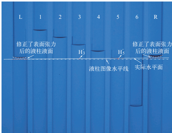
图4 包含8个液柱的液柱图像 Fig. 4 Typical image containing eight liquid columns
