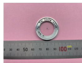
图8 BAS-SR型IP板能量响应实验用 ^{60}\text{Co}
