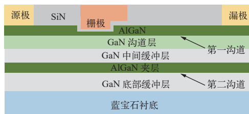
图 25 引入 AlGaN 夹层的 GaN HEMT 器件结构
