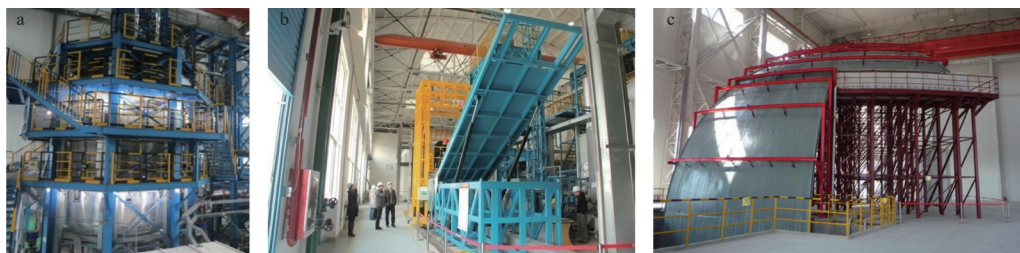
a——综合试验台架; b——水膜热态试验台架; c——水分配试验台架
