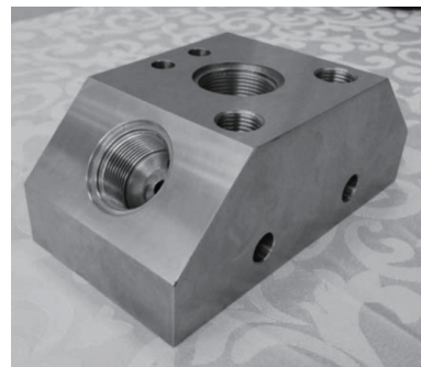
图3 3D打印的仪表阀阀体 [40]
