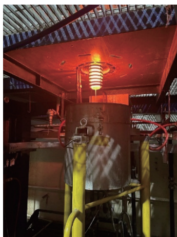
图7 \phi 300 mm冷坩埚玻璃固化实验装置 55 GW·d/tU 动力堆高放废液玻璃配方验证试验
