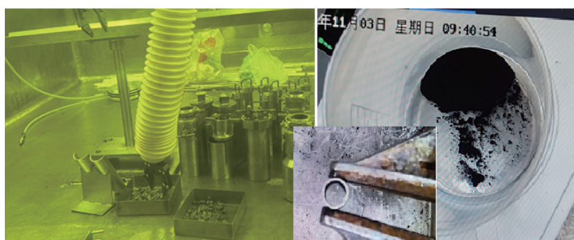
图8 乏燃料短段氧化前、后(粉末与包壳)实物
